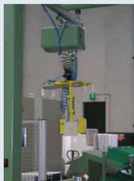
KROMATIC mit pneumatischen Hebern
